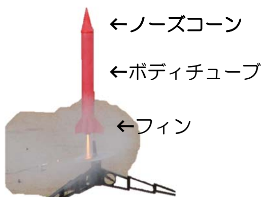
Figure 3 製作したロケット
